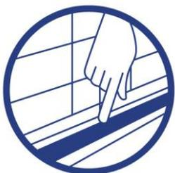
5. 將矽利康置入矽利康槍手工具中，擠壓至填縫處，以刮刀或其他適合工具將其抹平即完成修補動作。
