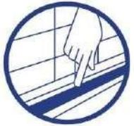
1. 適當清潔欲填縫之物體表面，確認無油漬及水分，必要時清潔後以風扇或熱風烘乾接著物體表面水分。
